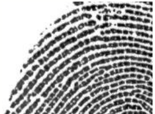
La impresión dactilar obtenida con el Bioidentidad Decadactilar es de tan alta calidad, que inclusive pueden apreciarse los poros ubicados en las crestas dactilares y otros detalles de análisis forense.
